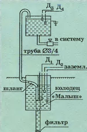
Принципиальная схема автоматического управления системы водозабора в индивидуальном хозяйстве
